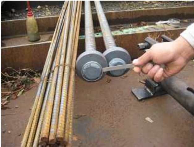
専用ゲージによる寸法検査 (先端ふくらみの確認)
