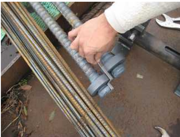
専用ゲージによる寸法検査 (ふくらみ保持角度の確認)
